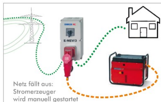
Interruzione di corrente: il generatore viene avviato manualmente
