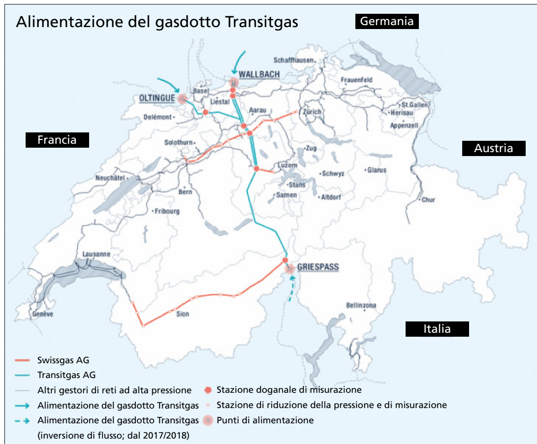
Figura 8: Alimentazione del gasdotto Transitgas
