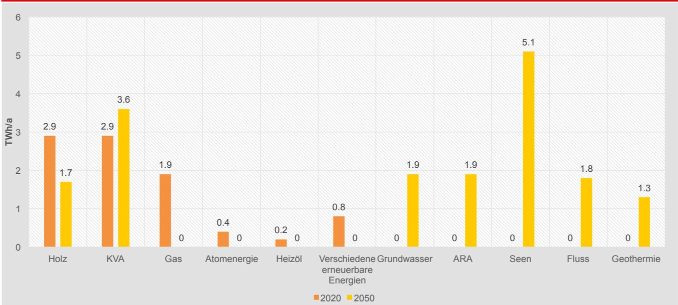
Abbildung 4: Entwicklung des Anteils der Energiequellen bis 2050
