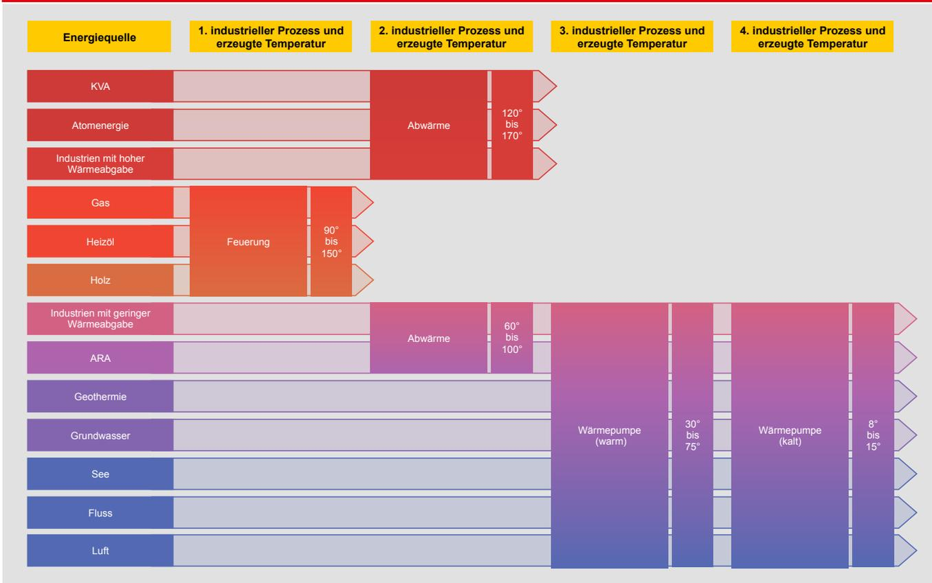
Abbildung 2: Energiequellen, industrielle Prozesse und erzeugte Temperaturen
