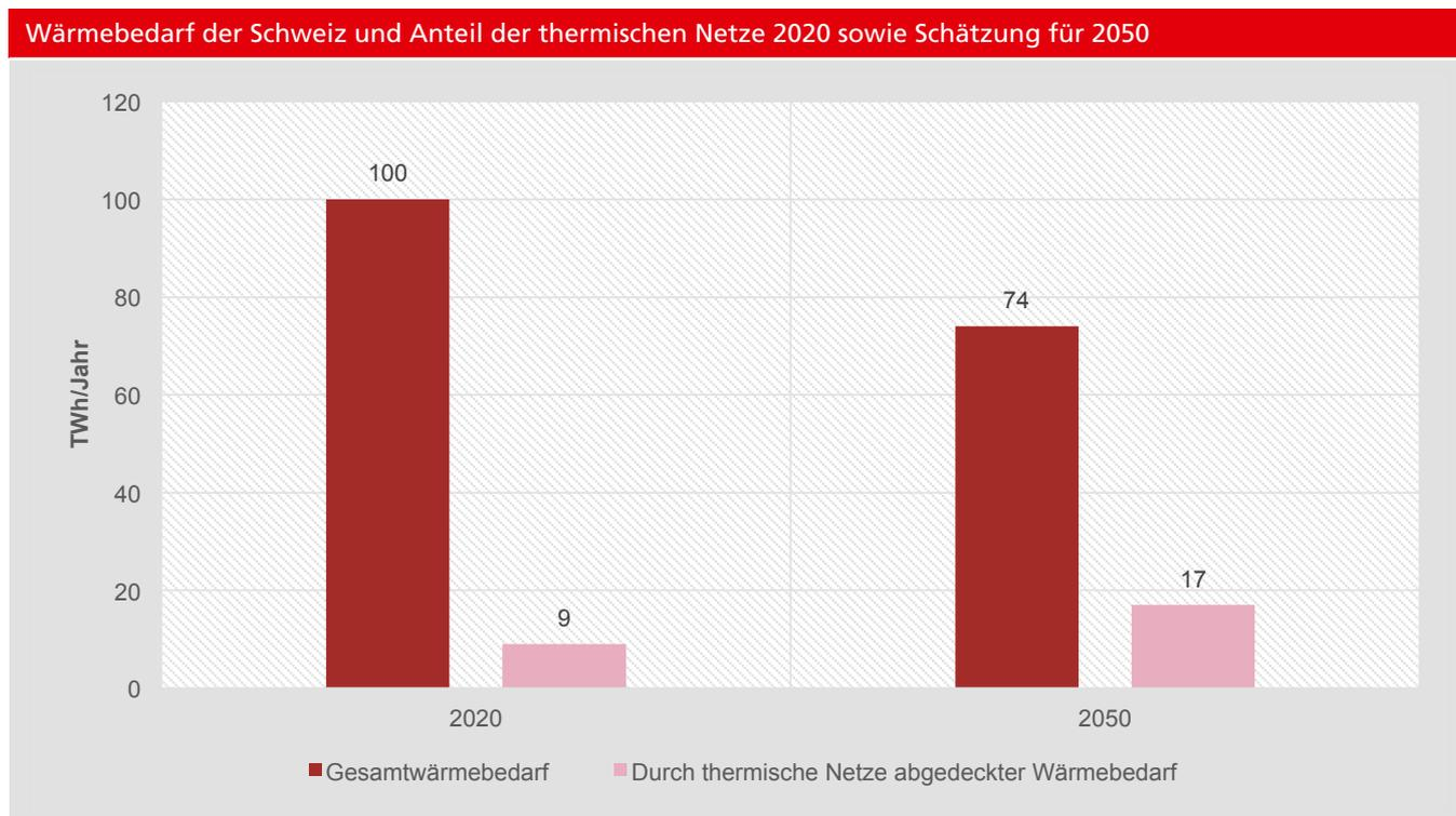
Abbildung 3: Wärmebedarf der Schweiz und Kapazität der thermischen Netze in den Jahren 2020 und 2050
