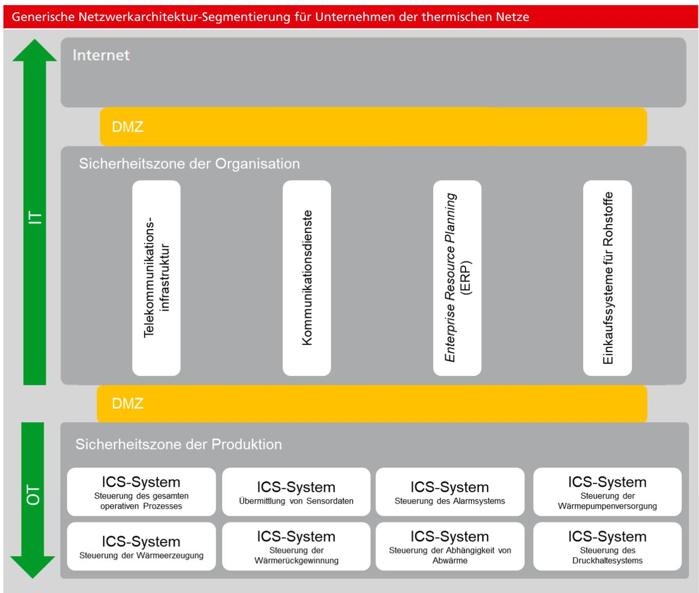
Abbildung 14: Generische Netzwerkachitektur-Segmentierung für Unternehmen der thermischen Netze
