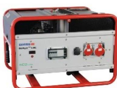
**Grössere Aggregate** werden mit Diesel betrieben (Leistungsbereich ab 6kVA/400V). Dieselmotoren sind Selbstzünder und haben ein robustes Lastübernahmeverhalten. Je nach Art der Last sind Zuschaltungen von 50% der Nennlast möglich. Diesel-Kraftstoff ist einfach lagerbar und nicht leicht entzündlich. **Für Notstromanwendungen ist Diesel daher der bevorzugte Kraftstoff.**
